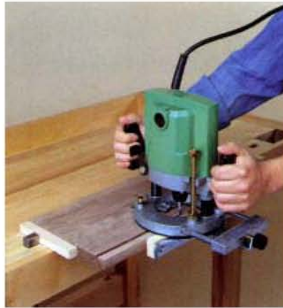
Прямая фреза вырезает паз по направляющей. Продвижение фрезера вдоль края направляющей производит рез параллельно краю.
