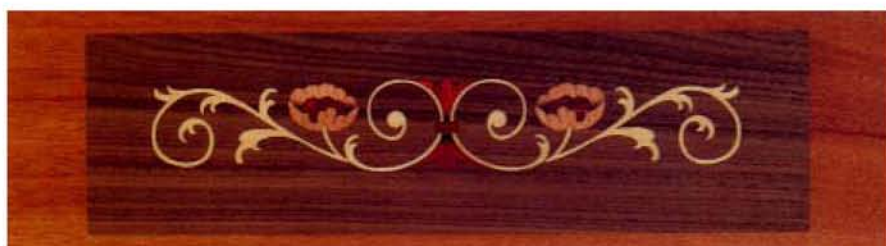
Инкрустация маркетри, набранная из кусочков окрашенного дерева в шпоне, украшает деталь из красного дерева. Инкрустация была вклеена в отфрезерованную выемку.
